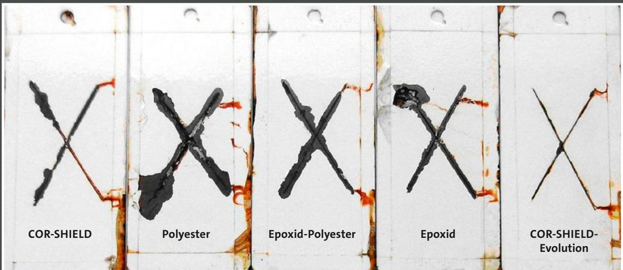
Um die Korrosionsbeständigkeit der COR-SHIELD-Evolution-Serie mit anderen Pulverlack-Systemen vergleichen zu können, wurde mit Testblechen aus Stahl ein neutraler Salzsprühtest (nach ISO 9227) durchgeführt. Die Testbleche wurden lediglich entfettet. So konnte der Korrosionsschutz des Pulverlacks ohne Überlagerungseffekte der Vorbehandlung geprüft werden.
