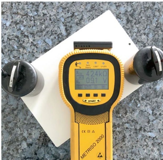
Messbeispiel der Ableitwiderstände auf einem DIN A4 beschichteten Musterblech.
